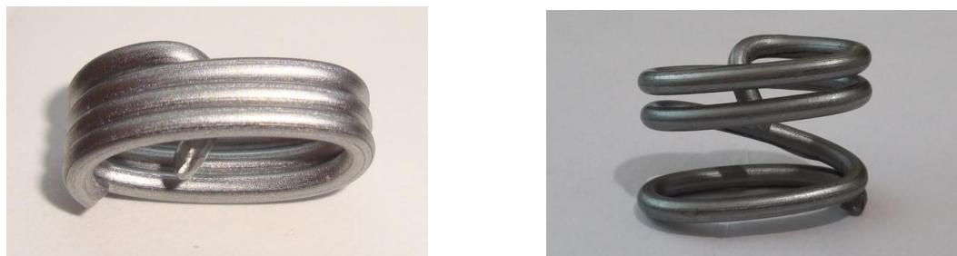
Рисунок 2 - Модель № 2 в рабочем и исходном состоянии
