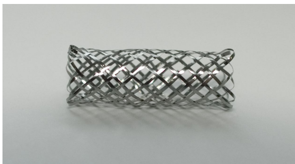
Рис. 1. Внешний вид эластичного стента из никелида титана марки ТН-10
